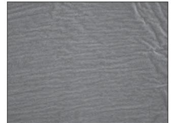
Ultradent Universal Dentin Sealant deckt das Dentin mit einer schützenden Versiegelung. Beide Oberflächen wurden 20 Sekunden mit Phosphorsäure konditioniert; REM rechts wurde vorher mit Ultradent Universal Dentin Sealant versiegelt.
