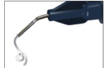
4. Setzen Sie den Spritzenstempel wieder ein und drücken Sie eine kleine Menge des Zements durch die Spitze heraus.
