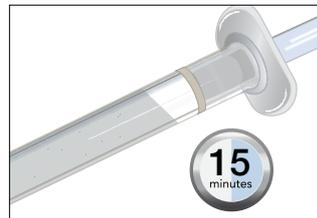
5. Der angemischte MTAFlow Zement im Inneren der Spritze ist bis zu 15 Minuten gebrauchsfähig.
