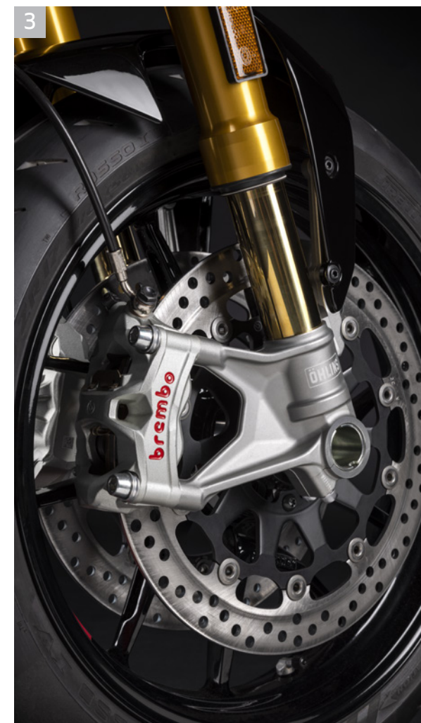
3 Pinze Brembo Stylema® ad attacco radiale a 4 pistoncini
