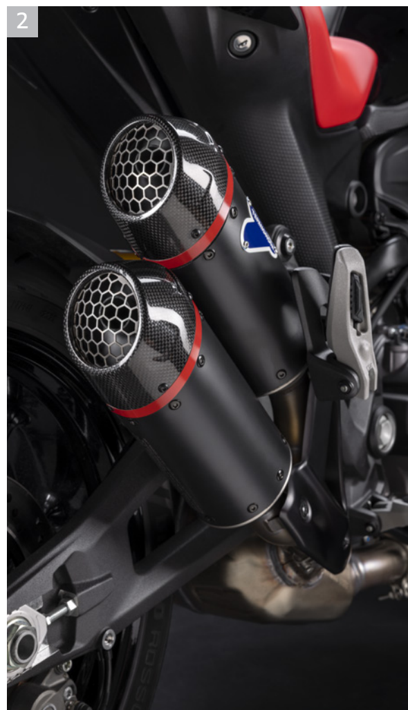
2 Pre-silenziatore e doppio terminale Termignoni omologato, catalizzatore e 2 sonde lambda
