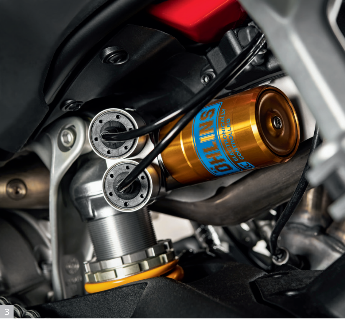
3 Öhlins Smart EC TTX36 damper
