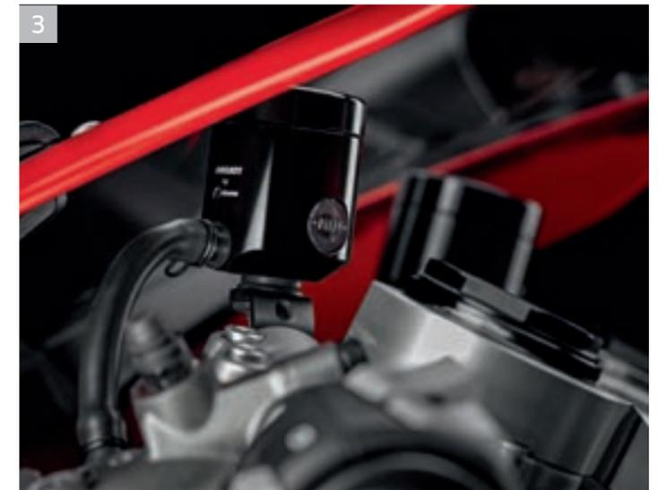
3 Serbatoio liquido freno e frizione.
