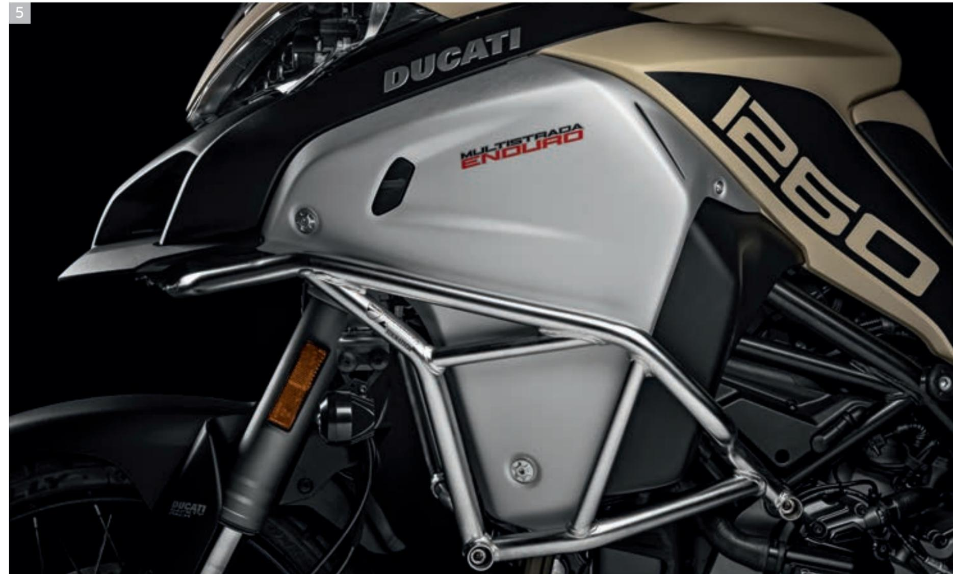
5 Protezioni laterali serbatoio in tubi d'acciaio.
