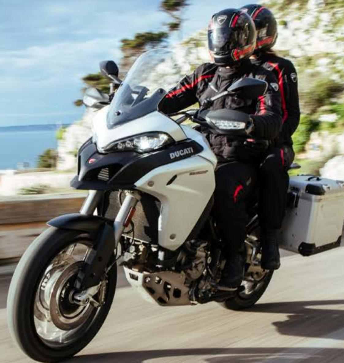
EQUIPAGGIAMENTO Cornering ABS regolabile su tre livelli - Riding Mode, selezionabile tra Touring, Sport, Urban, Enduro - Vehicle Hold Control per agevolare le partenze in salita - Fari full LED con funzione Cornering. Wheelie Control,
