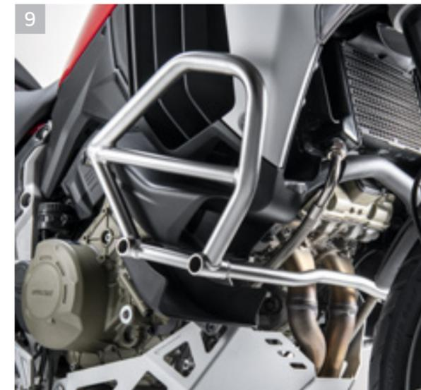
9 Paramotore in tubi d'acciaio.
