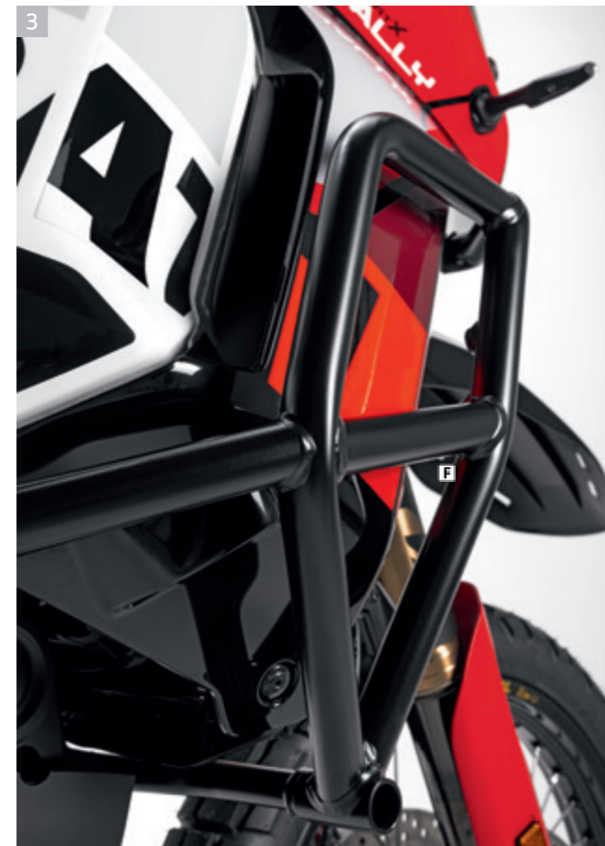
3 Paramotore in tubi d'acciaio.
