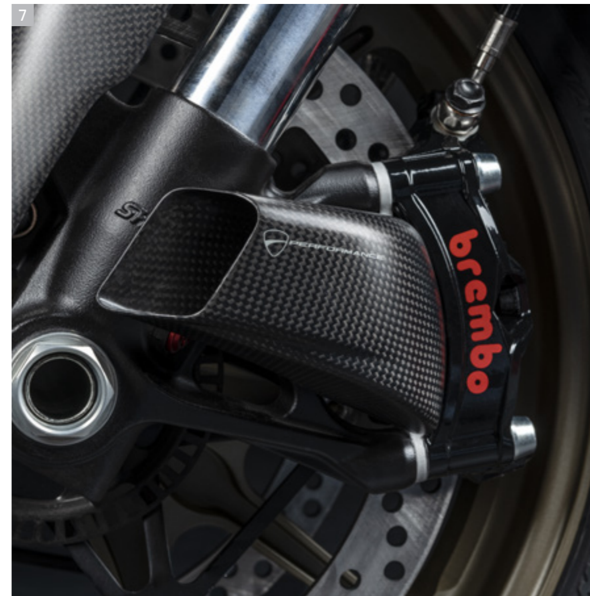
7 Condotti in carbonio per il raffreddamento freni. Pinze freno anteriori colorate.
