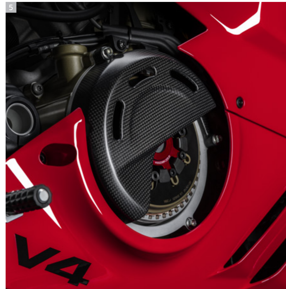
5 Kit frizione a secco. Cover frizione a secco.
