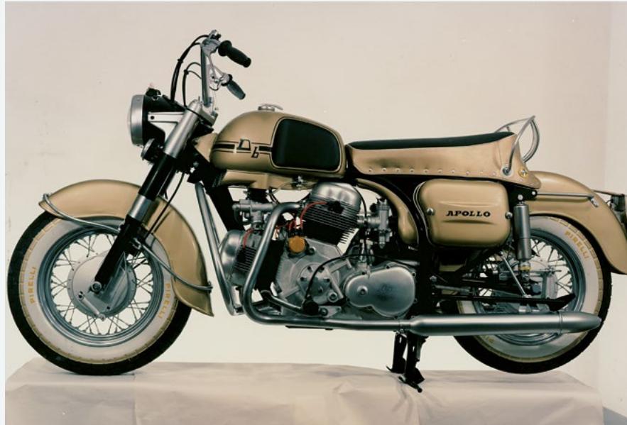
Le moteur de l'Apollo inspirera le bicylindre en « L », future marque de fabrique des motos Ducati.
